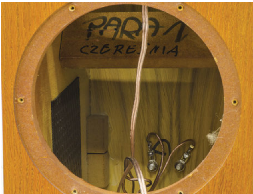
All'interno del mobile si notano dei listelli di rinforzo, la scritta in polacco indica la finitura in ciliegio (czereśnia).
