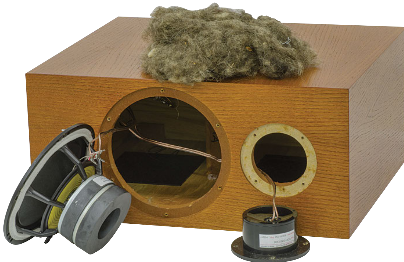
Il diffusore con gli altoparlanti rimossi. Si nota il doppio magnete sul woofer, incollato non tanto per la schermatura fine a se stessa quanto per ottimizzare alcuni parametri caratteristici del trasduttore. L'assorbente, presente in modica quantità, è lana di pecora e ha fornito alle misure una prestazione eccellente.
