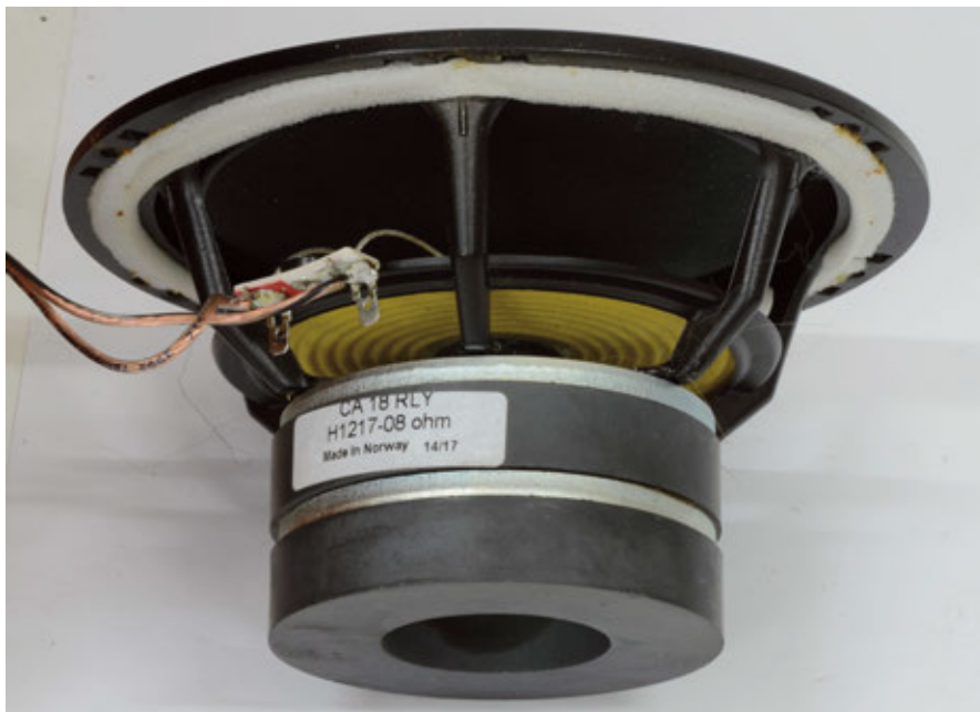
Il woofer da 165 mm è di produzione Seas anche se con una leggera variante. Notare i cavi saldati direttamente ai terminali.
