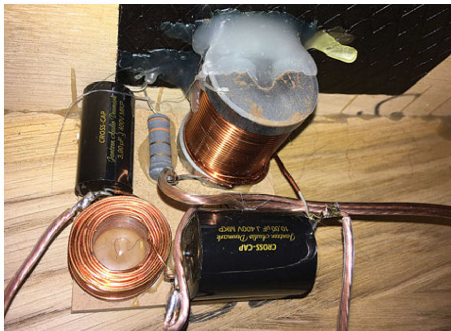
I componenti del filtro crossover sono saldati direttamente tra loro, senza circuito stampato, e incollati su un supporto in MDF fissato sulla parete di fondo del mobile. Notare i condensatori in polipropilene e il resistore in impasto di carbone che attenua l'emissione del tweeter.
